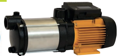
9650991 Caudal max 3900 L/H, 550W. Presión max: 4.3bar. Auto-aspirante hasta 2 m. Motor protección IPX5. Cuerpo bomba AISI 304 Eje bomba AISI 431 Temperatura máxima del agua 40°C. Versión monofásica con protección térmica incorporada. Se suministra sin cable.
